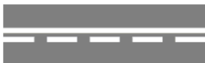
Líneas Blancas Longitudinales Continuas y Discontinuas
